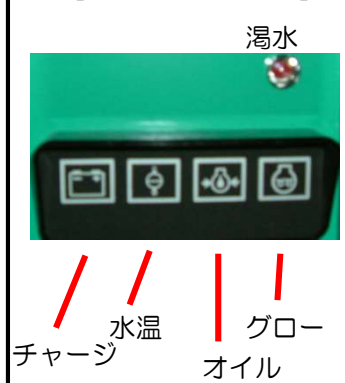
【パイロットランプ】
