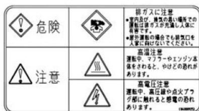
L08 危険・注意 排ガス・高温
